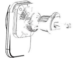
3. Drehen Sie die Umlenkrolle nach links, um den Haken auf die größte Länge einzustellen.
